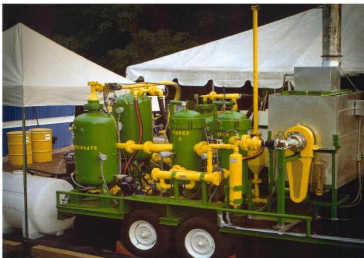
Рис. 9 . Вакуумная вращающаяся реторта, смонтированная на прицепе.
