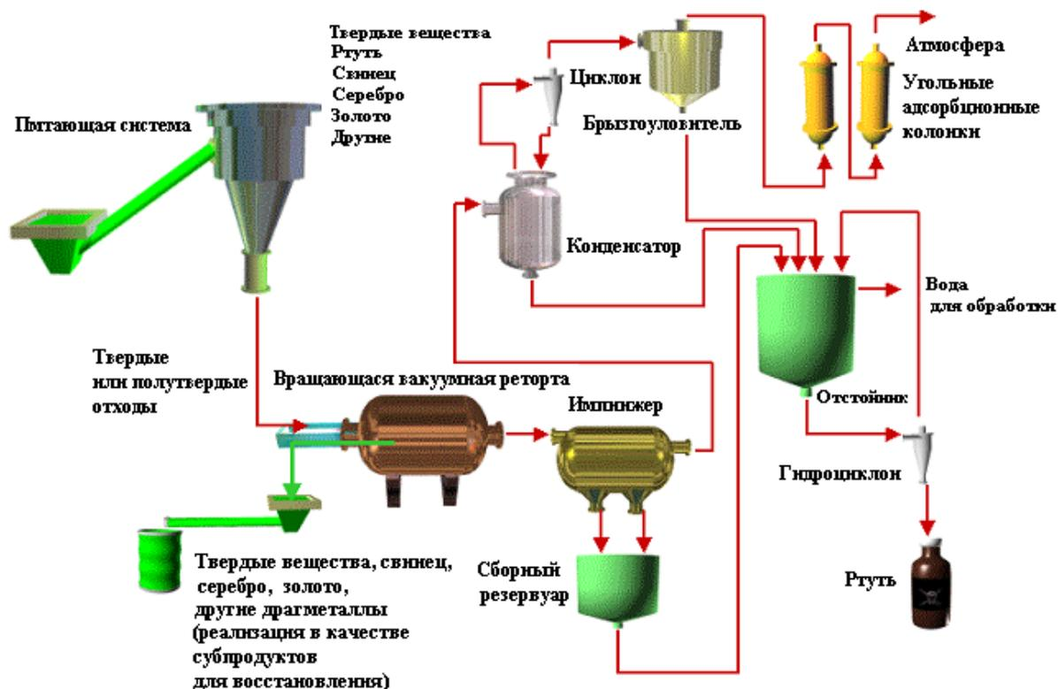
Рис. 8. Схема процесса *SepraDyne*.
