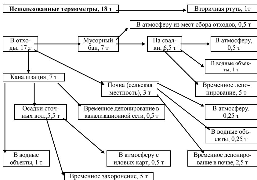
Рис. 5. Схема распределения ртути, содержащейся в ежегодно используемых (выходящих из строя) в России ртутных термометрах.
