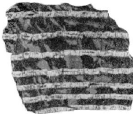
Рис. 5. Прожилки асбеста в змеевике, Баженовское месторождение [53]
